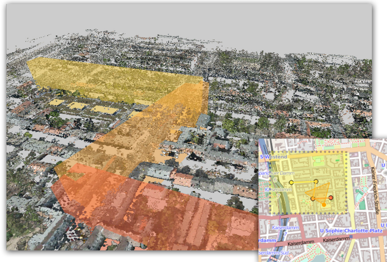
Gemeinsame Visualisierung der Korridore und der Schnittebenenausrichtung in der gerenderten 3D-Punktwolke und in der Minimap.
